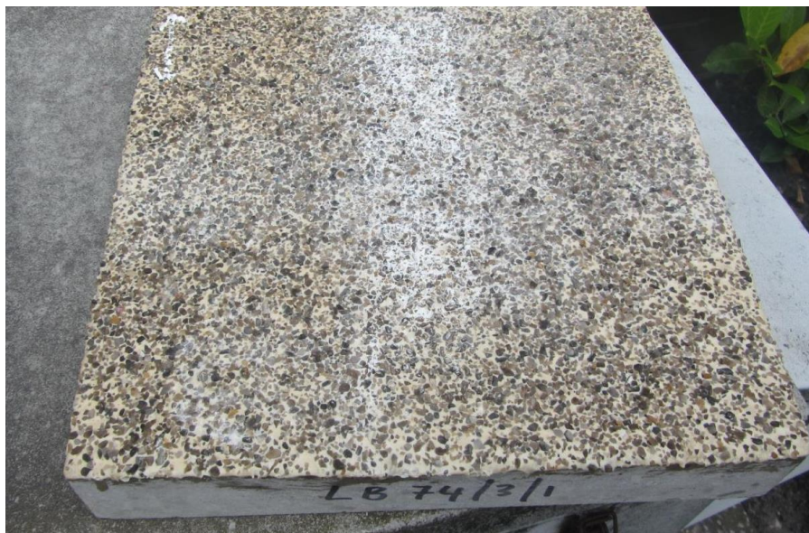
2. kép Az aggregáttal szórt Eliminator minta utóvizsgálata enyhe elszíneződést mutat
